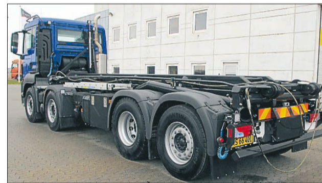
Udover vejecellerne er lastbilen udstyret med et såkaldt hejse-lad, der kan hejse helt af lastbilen. Foto: HMK Bilcon
