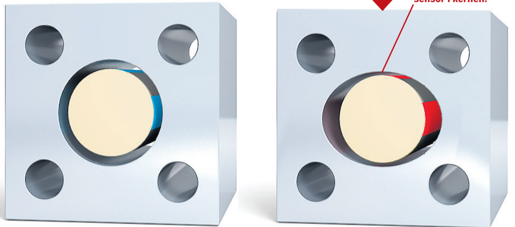
Eilersens vejeceller bygger på et kapacitivt måleprincip, hvor påvirkning af den ydre stålklods aflæses som afstandsændring i forhold til keramiksensoren. Det gør dem både robuste og præcise.
